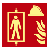
Ref. 17 Ascensor para los servicios de emergencia
