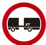
Ref. R-112 Entrada prohibida a vehículos con remolque que no sean un semirremolque o un remolque de un solo eje
