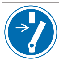
Ref. 259 Desconectar antes de reparación
