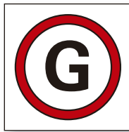
Ref. 2.34 Fuente de energía eléctrica de emergencia (generador)
