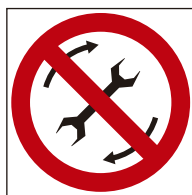
Ref. 482 Prohibido reparar la máquina en funcionamiento
