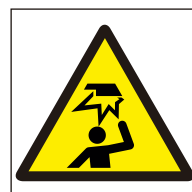
Ref. 398 Peligro Objetos fijos a baja altura
