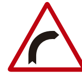
Ref. P-13-A Curva peligrosa hacia la derecha
