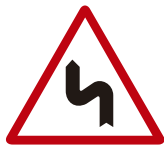
Ref. P-14-B Curvas peligrosas, la primera hacia la izquierda
