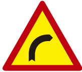
Ref. TP-13-A Curva peligrosa hacia la derecha
