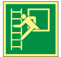
Ref. ISO 52 Ventana de emergencia con escalera de escape
