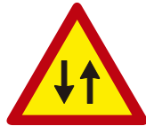
Ref. TP-25 Circulación en los dos sentidos
